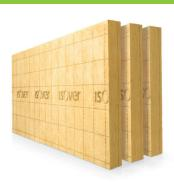
Isover® comfortpanel 32 est un panneau en laine de verre, revêtu sur les deux côtés d'un voile doux protecteur et muni d'un côté d'une entaille longitudinale. Un prémarquage tous les 10 cm facilite les découpes sur mesure.
