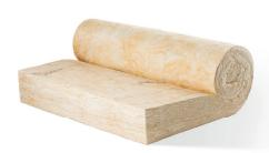
Isover® Isoconfort 32 est un rouleau en laine de verre revêtu d'un voile doux en polyester, conditionné sous forme de rouleau pour le transport. Un prémarquage tous les 10 cm facilite les découpes et permet à Isoconfort 32-35 de s'adapter aux différents entre-axes présents entre les chevrons de toiture.
